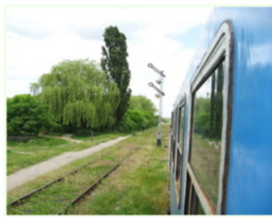
Semnal feroviar de epocă. În poziția din imagine, cu două brațe ridicate, indică mecanicului „cale liberă pe linie abătută”, așadar cu viteză redusă
